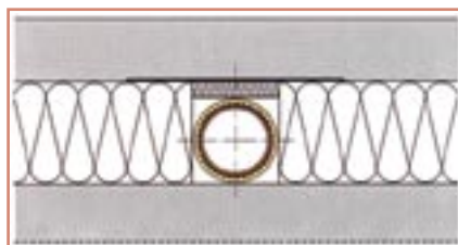
Obr. č. 38 Správně provedená podlahová instalace (suchá)
